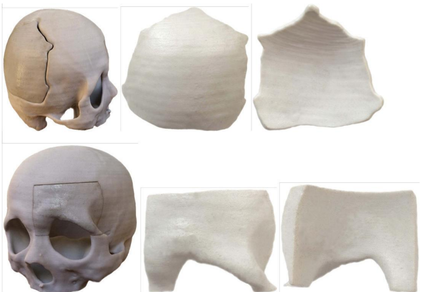
Рисунок 9 – Изготовление имплантата из биоцемента на основе полиметилметакрилата
